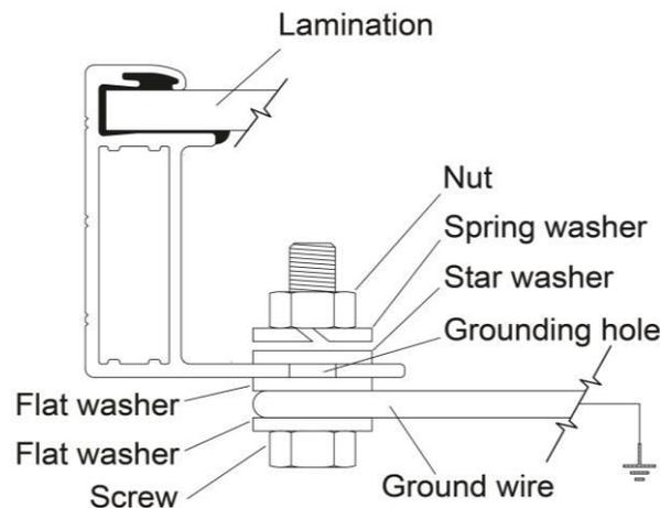
2) Verwenden Sie das WEEB-DPF Bauteil für die Verbindung der Solarmodule mit dem Montagesystem (Erdungsteile gemäß UL467 getestet).
