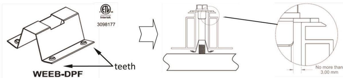
Geben Sie acht, dass die Zähne des WEEB vollständig unter der Kante des Modulrahmens zu liegen kommen. Wenn die Positionierung der Solarmodule beendet ist, ziehen Sie die Befestigungsschrauben mit 20,5 Nm fest. (Behandeln Sie die Gewinde zuvor mit Allzweck-Gleitmittel). Für weitere Informationen wenden Sie sich bitte an den Hersteller: BURNDY, <http://www.we-llc.com>
